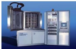
Postupak se izvodi prevođenjem materijala u parno stanje, transportom do površine tela na kome se prevlaka nanosi i deponovanjem materijala prevlake na izabranu površinu
