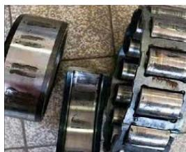
Primer utiskivanja kod kotrljajnih ležajeva
